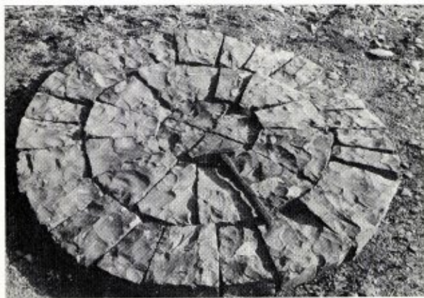
In model uitgelegde vuursteenblokken, bestemd voor de binnenbekleding van een maaltrommel in de fijn-keramische industrie. Foto: ing. P. J. Felder.
